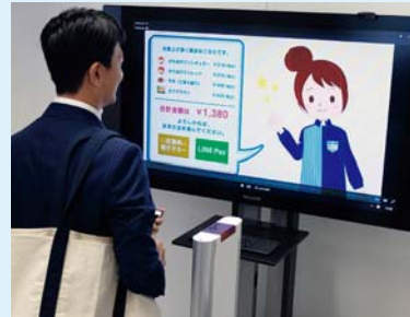
商品を袋に入れゲートを通るだけで袋に入れた商品が画面に瞬時に表示される
