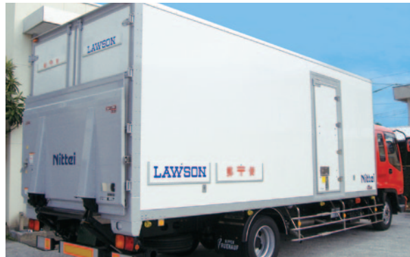
郵便事業株式会社のトラックに定温コンテナを設置し、各種温度帯の商品を配送
