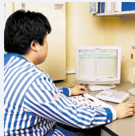
ストアコンピュータ 店舗の事務室にある発注処理と商品管理のためのシステムです。本部のホストコンピュータと直結し、製造や配送量を調整します。
