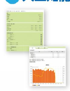
各所に設置したセンサーで店内外の環境を検知し、人工知能で最適な機器制御を行って、店舗のエネルギーマネジメントを自動化。
